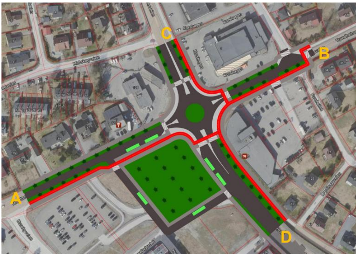
Figur 2-6: Prinsippskisse som viser hvordan veinettet tenkes omformet til gatestruktur med bredt fortau, trekker og separat gang- og sykkelvei (rødt). Kilde: Saksfremlegg «Områderereguleringsplan for Skedsmokorset øst – prinsippvalg» til møte i Hovedutvalg for miljø og samfunn 13.03.2024.
