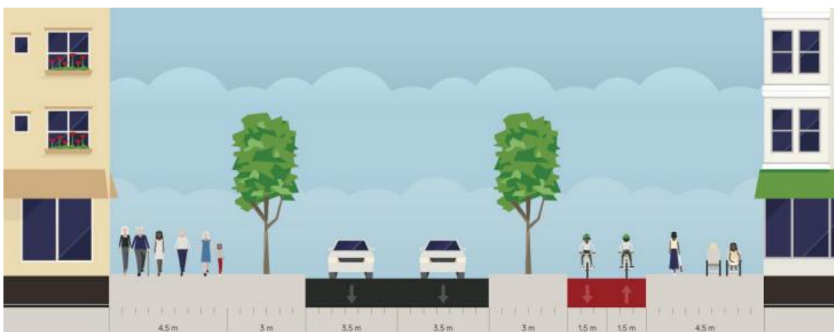
Figur 2-7: Prinsippsnitt hovedløsning langs Trondheimsveien (fra Husebyveien til Korshagen). Kilde: Saksfremlegg «Områderereguleringsplan for Skedsmokorset øst – prinsippvalg» til møte i Hovedutvalg for miljø og samfunn 13.03.2024.
