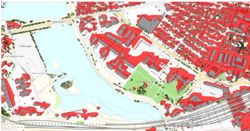
Figur 19 Kart som viser områder med skygge i tre timer eller mer ved vårjevndøgn (markert med rødt). Kilde: Origo
