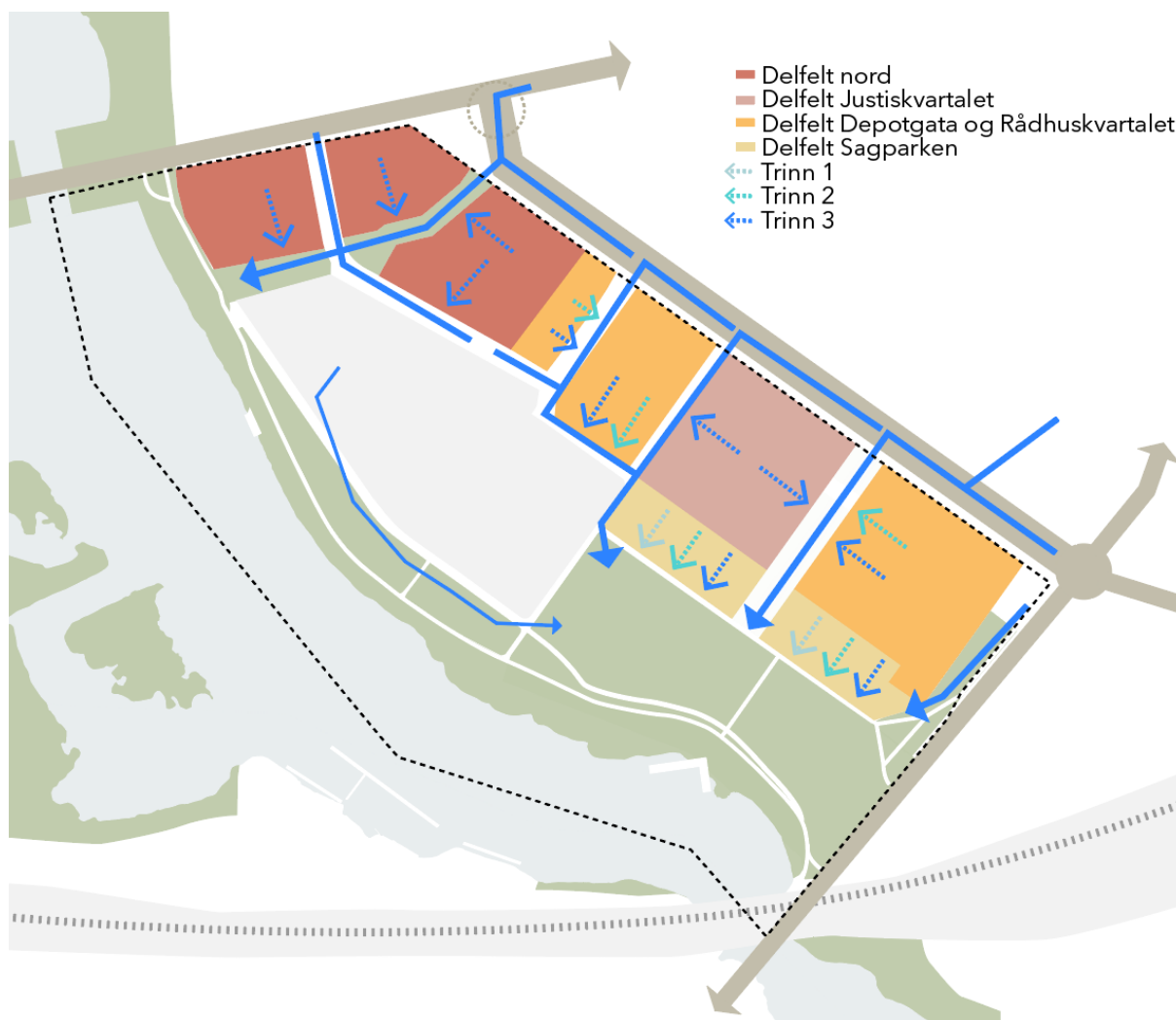
Figur 12 Delfelt for overvannshåndtering innenfor planområdet
