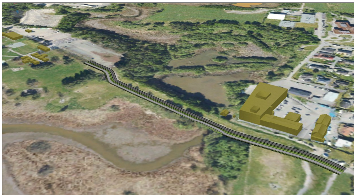
Figur 3: Enkel skisse som viser mulig utforming av gang- og sykkelveien inntil dagens kjørevei. Området hvor GS-veien skal knyttes mot eksisterende løsninger er ikke detaljert utformet og må vurderes nærmere i videre planarbeid.
