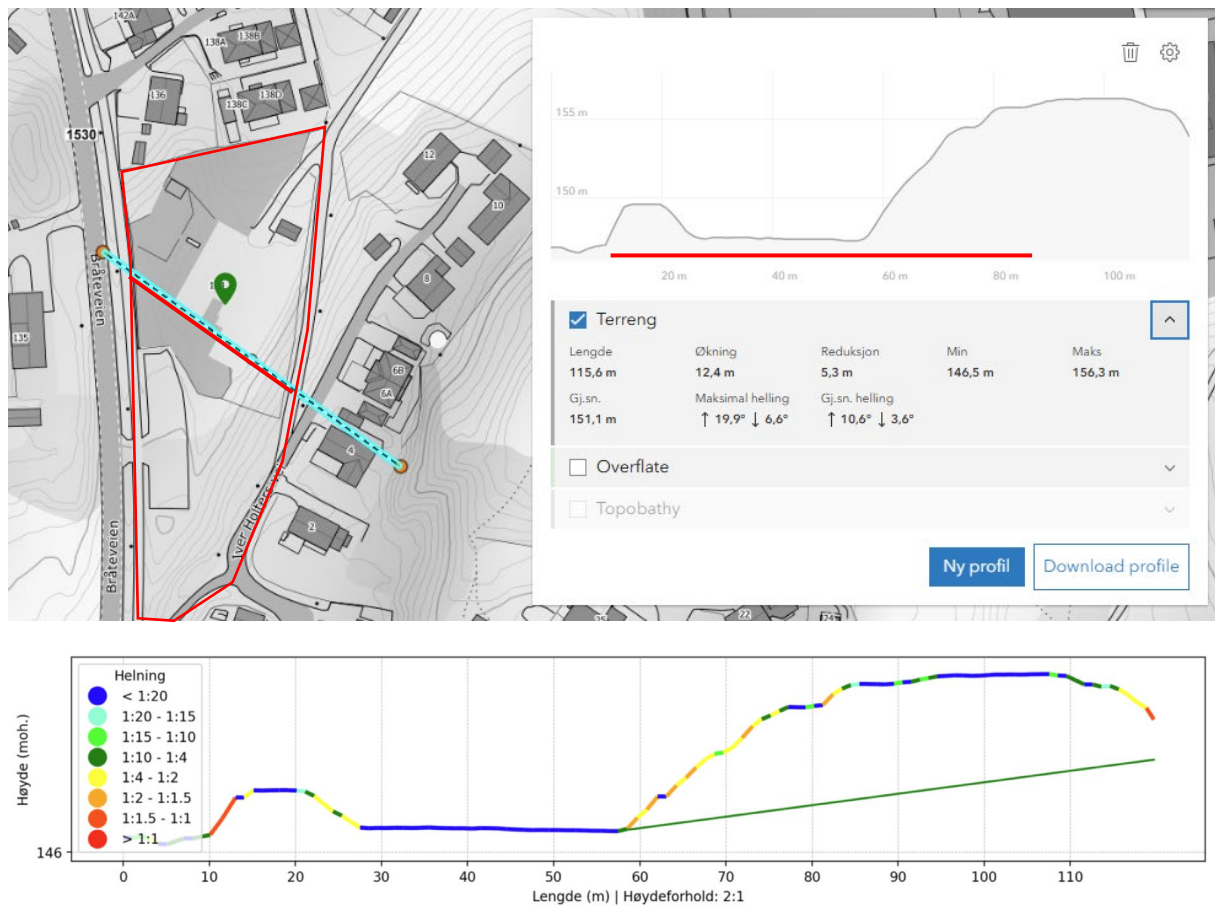
Figur 6. Profil fra nord-vest mot sør-øst gjennom planområdet laget i høydedata [5]. Profilet viser at det er en høydeforskjell på mer enn 5 meter i antatte løsmasser i sør-øst og at helningen er brattere enn 1:15. Planområdet er innenfor både et potensielt utløsning- og utløpsområde for kvikkleireskred.
