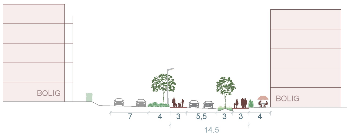
Figur 35. Snitt 1.1b - Depotgata mellom eksisterende boligbebyggelse i Elveparken boligsameie (til venstre) og ny bebyggelse i felt 3, sett mot Nittedalsgata.
