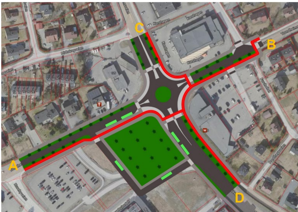
Figur 2-6: Prinsippkisse som viser hvordan veinettet tenkes omformet til gatestruktur med bredt fortau, trekker og separat gang- og sykkelvei (rødt). Kilde: Saksfremlegg «Områderereguleringsplan for Skedsmokorset øst – prinsippvalg» til møte i Hovedutvalg for miljø og samfunn 13.03.2024.
