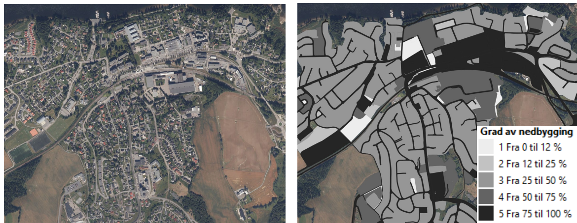
Figur 24. Andel nedbygd areal. Sørumsand. Original målestokk 1:5000.
