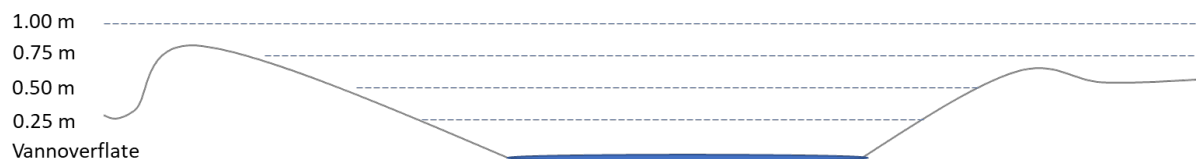
Figur 30: Tverrsnitt av vannmettet område og områder som kan bli vannmettet ved stigende vannmengde. Dersom terrenget består av løsmasser vil vann også trenge inn i grunnen.
