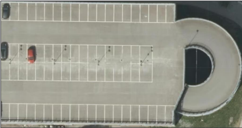
Figur 4-5 Eksempel på en arealeffektiv parkeringsløsning med separat toveis spiralrampe utenfor parkeringsradene (flyfoto: Finn kart)
