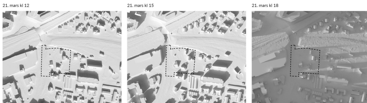
Figur 8 Illustrasjon som viser solforhold på vårjevndøgn for eksisterende situasjon
