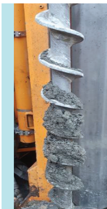
Bilde 3.14 P18: Dybde 0-1 m. Fyllmasser. Kilde: R3 AS
