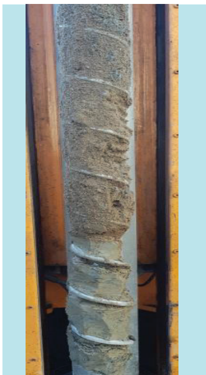
Bilde 3.16 P25: Dybde 0-1 m. Tørreskorpe og tørr siltig leire. Kilde: R3 AS
