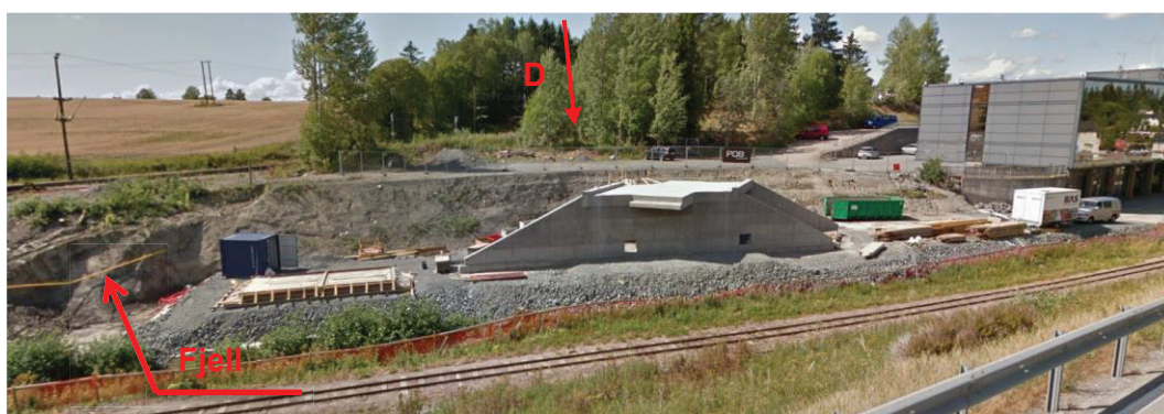
Bilde 4.4 Bilde tatt i nærheten av plassering av borpunkt C, stedlige løsmasser af sand og silt samt fjell til venstre på bilden. Grunnvann er ikke synlig.
