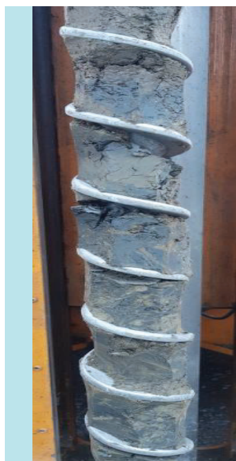
Bilde 3.13 P8: Dybde 1-2 m. Leirig silt, blir finkornigre med økt dybde. Kilde: R3 AS
