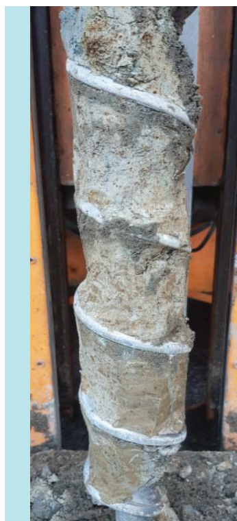
Bilde 3.21 P26: Dybde 1-2 m. Silt. Kilde: R3 AS
