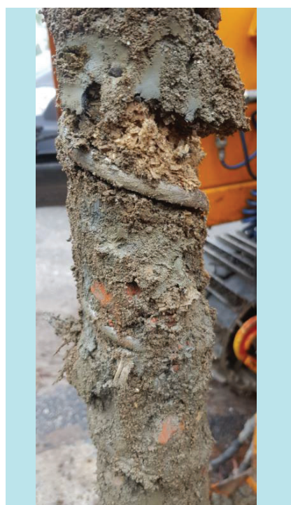
Bilde 3.19 P21: Dybde 1-2 m. Siltig leire med trerester Kilde: R3 AS
