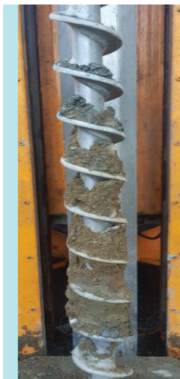
Bilde 3.20 P26: Dybde 0-1 m. Tørrksorpe. Kilde: R3 AS
