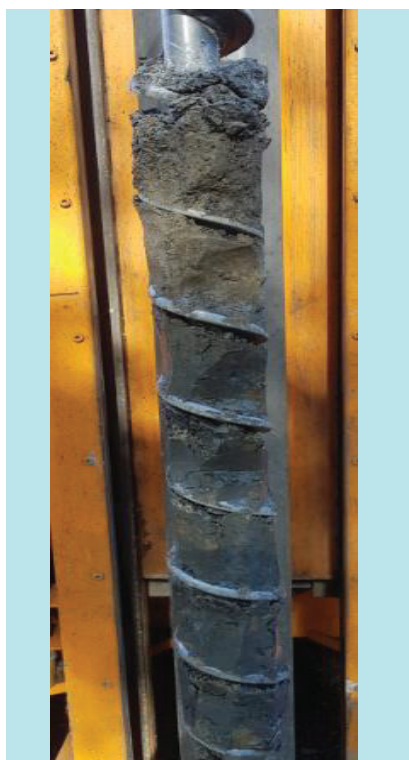
Bilde 3.22 P35: Dybde 0-1 m. Tørrksorpe og siltig leire. Kilde: R3 AS
