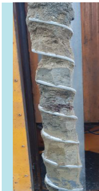
Bilde 3.12 P8: Dybde 0-1 m. tørskorpe og leirig silt. Kilde: R3 AS
