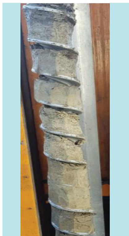
Bilde 3.17 P18: Dybde 1-2 m. Tørr leirig silt. Kilde: R3 AS
