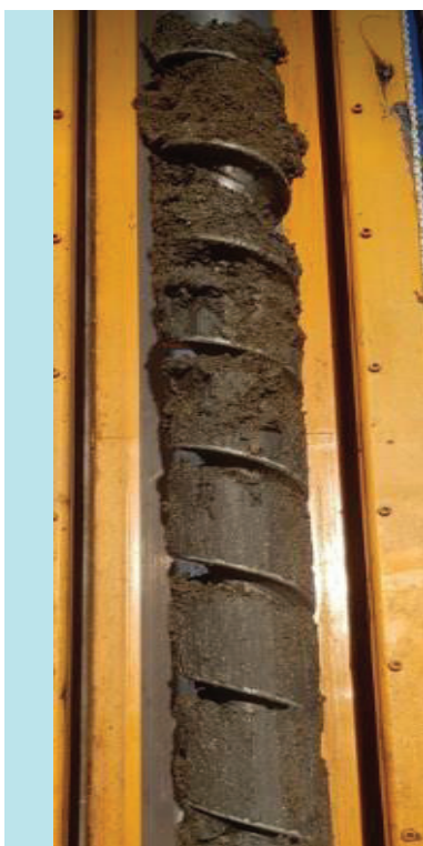
Bilde 3.24 P43: Dybde 0-1 m. Tørrskorpe og siltig leire. Kilde: R3 AS
