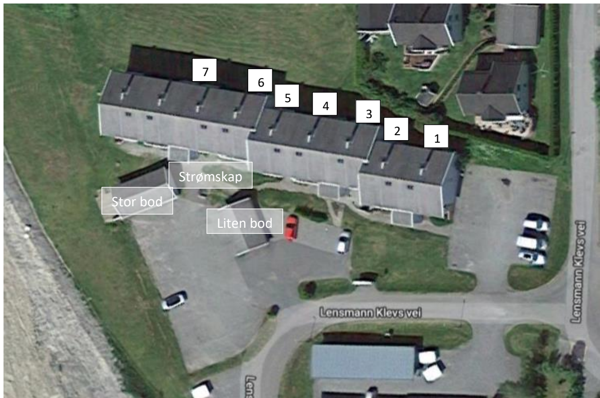
Figur 1. «Stor bod», «Liten bod» og «strømskap» i tilknytning til Lillehaugen borettslag der det er målt for metangass. Lufterørene fra grunnmur (nummeret 1-7) er plassert på baksiden av Lillehaugen borettslag.
