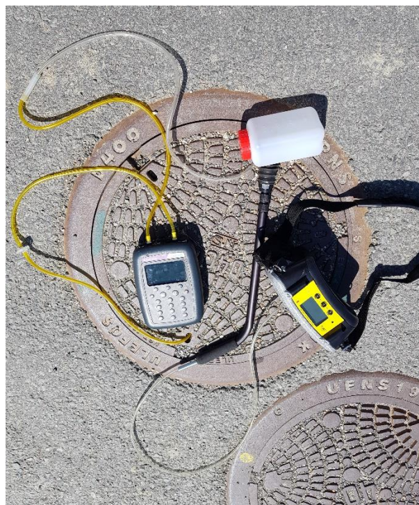
Figur 1. Måleinstrumentene SENSIT PMD og GA 5000 er koblet sammen for å måle metan i kummer.
