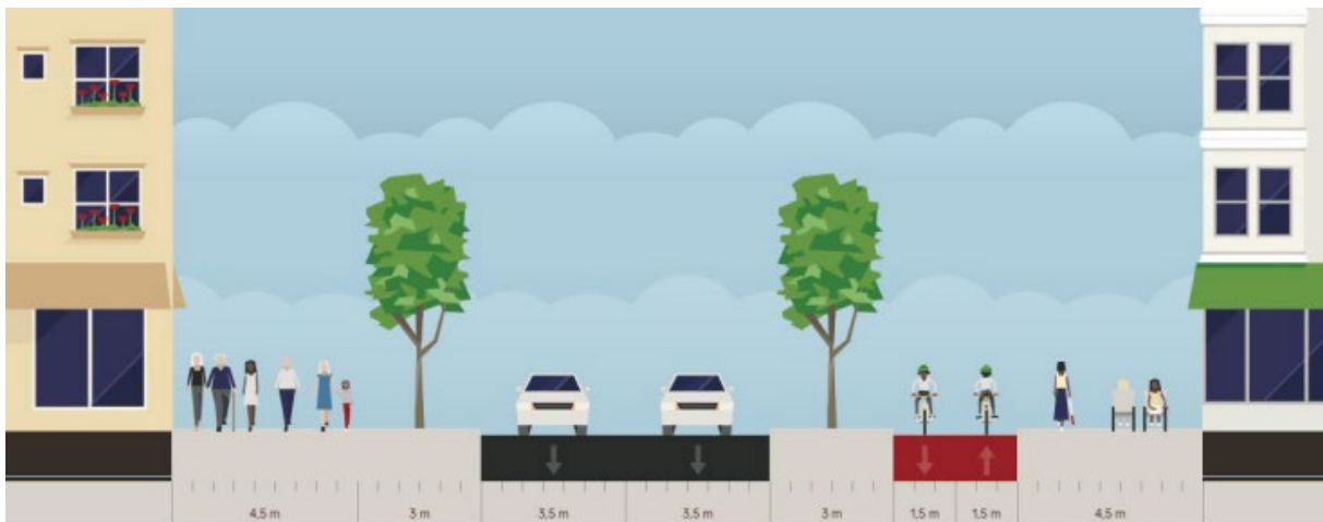
Figur 2-6: Prinsippsnitt hovedløsning langs Trondheimsveien (fra Husebyveien til Korshagen). Kilde: Saksfremlegg «Områdereguleringsplan for Skedsmokorset øst – prinsippvalg» til møte i Hovedutvalg for miljø og samfunn 13.03.2024.
