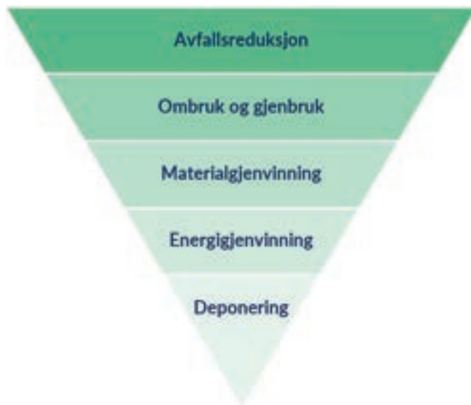
Figur 3: Den omvendte avfallspyramiden består av fem nivåer, hvor målet er at avfallet skal behandles så nært toppen av pyramiden som mulig.
