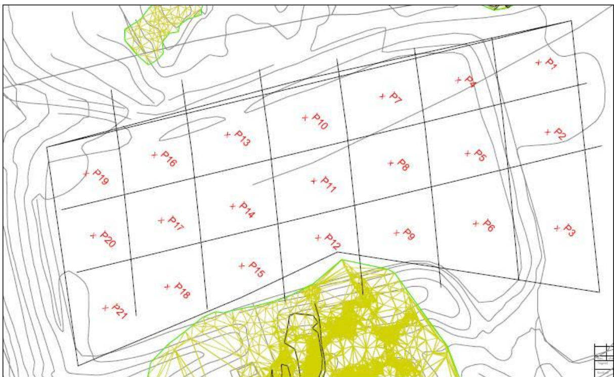
Figur 4. Inndeling av skytefeltet på felt Z i rutenett. Det ble gravd supplerende prøvegroper i P1-P12.
