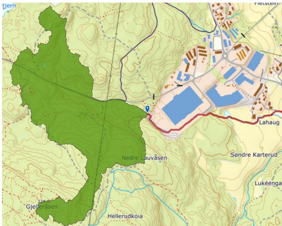
Figur 2: Nedbørfeltet beregnet med Scalgo.
