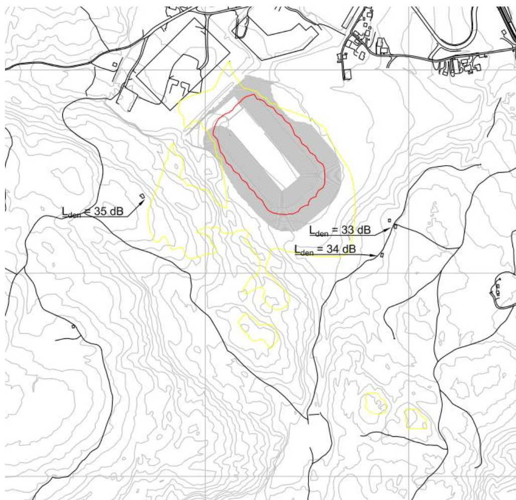
Figur 9-2. Grovberegnete støysoner ved L_{den} i alternativ 3, for alle baner samlet med mye skyting både dag og kveld. Gul sone: 35dB; rød sone: 45dB. Kilde: Rieber, 2022. Kartet viser scenario der bruk av skyttebanen genererer med mest støy. For andre scenarioer med mindre skyteaktivitet henvises det til Rieber (2022).
