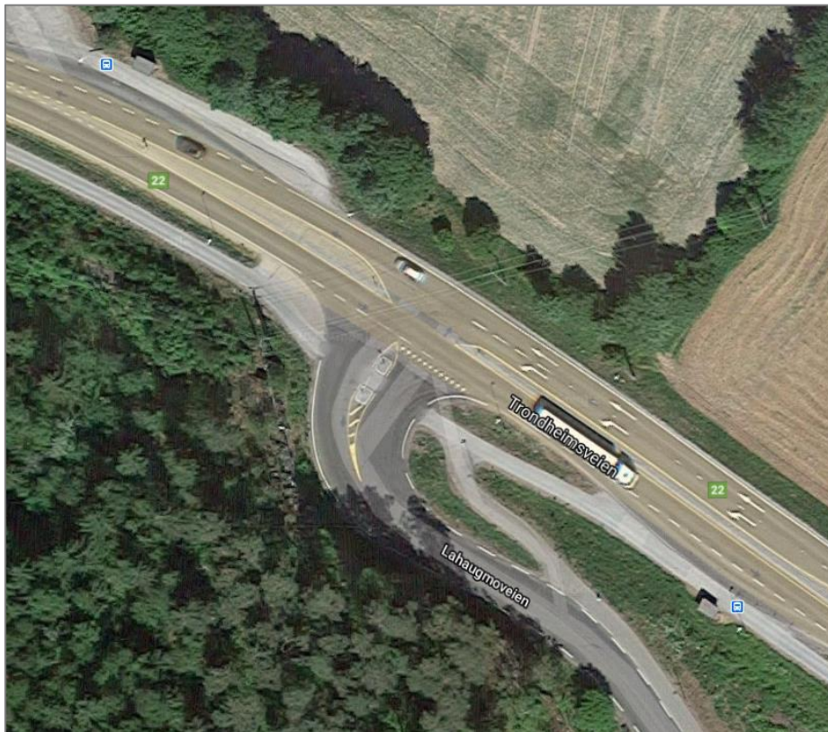
Figur 5: Flyfoto av krysset fv.22 Trondheimsveien x Lahaugmoveien. Det er gang- og sykkelvei langs Trondheimsveien og fortau langs østsiden av Lahaugmoveien (kilde: Google maps)
