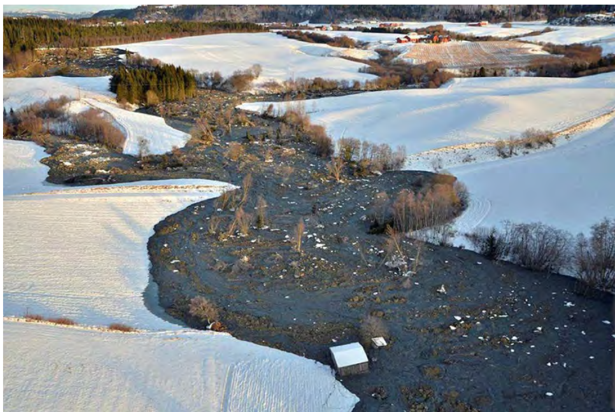
Figur 12 Kvikkelireskredet på Byneset i Trondheim 2012. Skredet ble utløst av en bekk som vokste og gravde seg inn i løsmasser.
